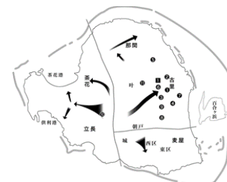
サンゴ礁を含む与論島の地形図に、地下水流と水道原水の取水井戸を書き込んだ。陸域の富栄養化物質が海域に流出している。
